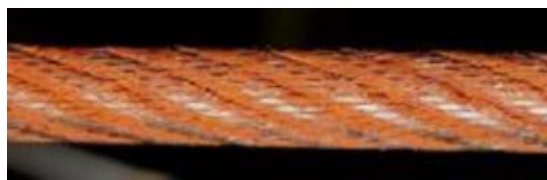
図 4-11 摩耗粉が付着した状態の例
